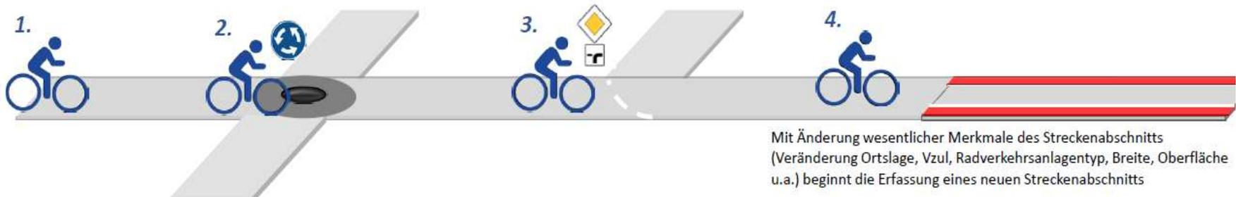
Mit Änderung wesentlicher Merkmale des Streckenabschnitts (Veränderung Ortslage, Vzul, Radverkehrsanlagentyp, Breite, Oberfläche u.a.) beginnt die Erfassung eines neuen Streckenabschnitts
